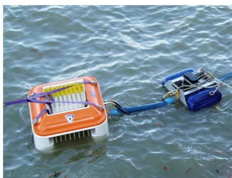
Komara Midi 2: 20m 3 pr time. Vægt: 38 kg. Mål: 88x88x43cm. 2 skimmer-moduler (duplex).
