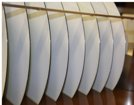
Diske opsamler 98% olie. Skimmere m. Duplex system kan skifte mellem diske og børster.
