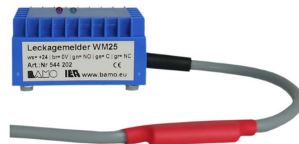
WM25: Gulvlækage-punktføler. Uden fødder: 0 mm væske. Med fødder: 2-5 mm væske.
